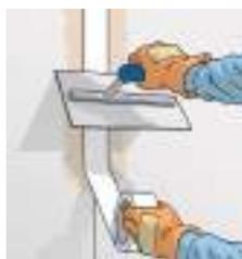
Traiter les joints avec une bande de renforcement dans un enduit de lissage.
